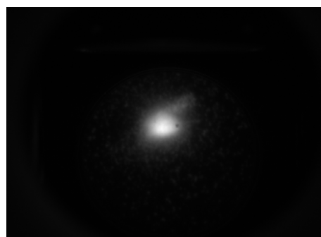
図 9: MCP による 5 eV 陽電子ビームの計測例。
