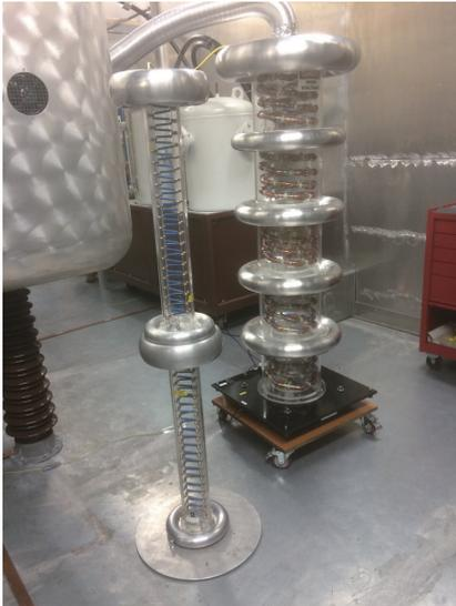
図 6: 実験に用いた高電圧分圧器の写真.
