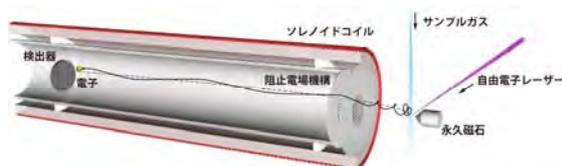
図 1. 磁気ボトル型光電子分光器の概念図
