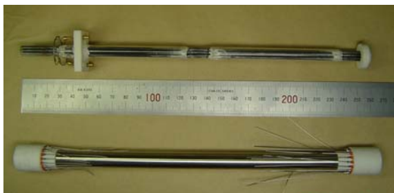
写真1 上段: 1.5φ 8Mo-rod 電極型ガイド、 下段: 0.5φ 16SUS-wire 電極型ガイド
